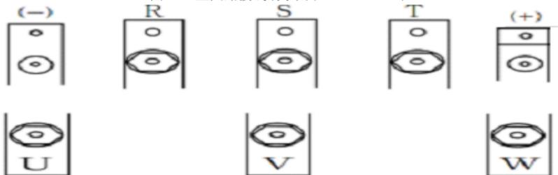
图 4-5 主回路接线端子图 (110kW~315kW)
