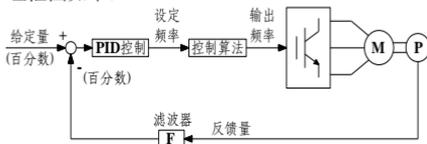
图 6-22 过程 PID 原理框图
