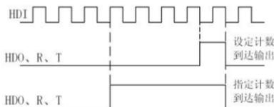
图6-18 设定计数值和指定计数值示意图
