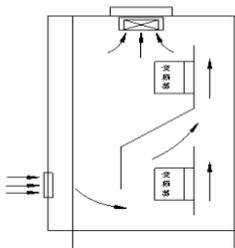
图 3-2 多台变频器安装示意
