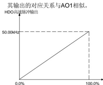
图 6-15 给定量与高速脉冲输出的对应关系
