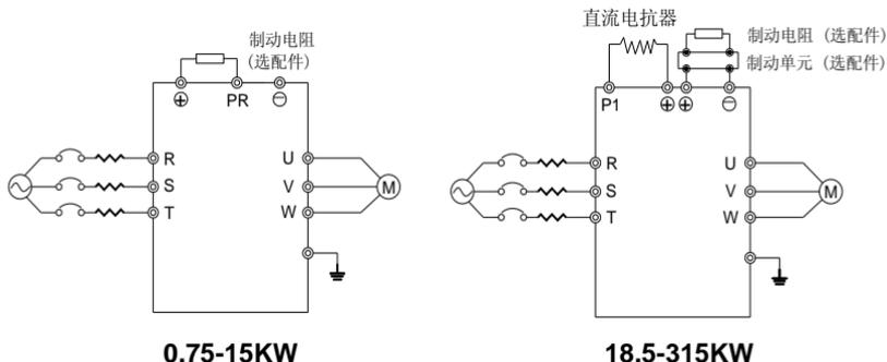
图 4-7 主回路标准接线图
