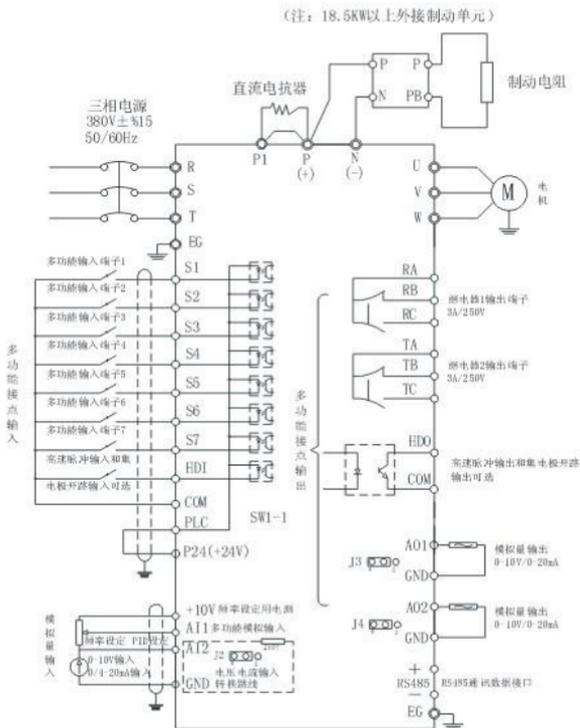
图 4-9 控制回路标准接线图
