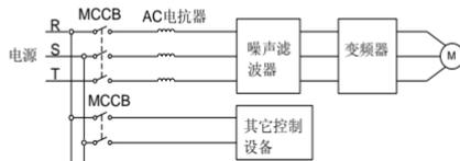
图 4—8 主回路电源侧连接图
