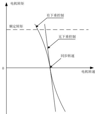
图6-21 下垂控制电机特性示意图
