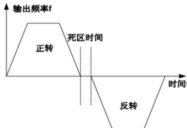
图6-6 正反转死区时间示意图
