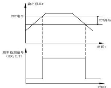
图6-19 FDT电平示意图
