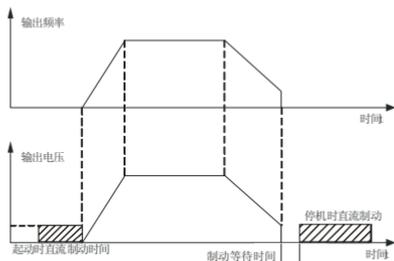
图6-5 直流制动示意图
