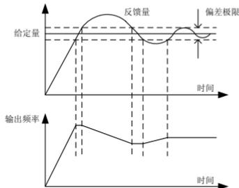
图 6-23 偏差极限与输出频率的对应关系
