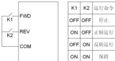
图 6-9 两线式控制（使能与方向合一）
