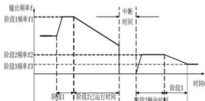
图6-26 简易PLC启动方式1
