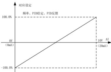
图 6-13 模拟给定与设定量的对应关系
