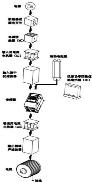
图 4-1 外围设备连接图
