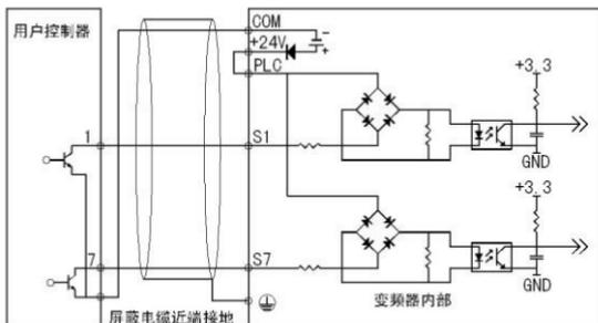
使用变频器内部+24V电源，外部控制器为PNP型拉电流接线方式，如下图：
