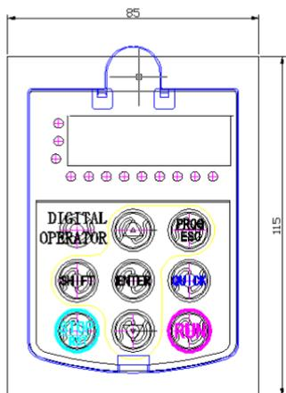
图 3-6 外引键盘的开孔尺寸
