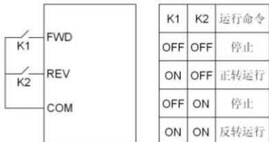
图 6-10 两线式控制(使能与方向分离)
