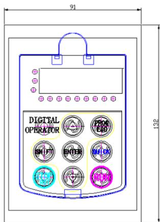
图 3-7 外引键盘的安装尺寸
