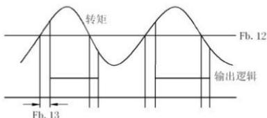
图6-30 过转矩控制示意图
