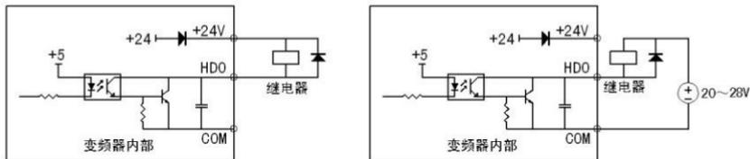
注：用此接线方式时若出现 HDO 端子损坏请务必确认外接二极管极性是否正确。
