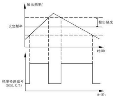
图6-20 频率到达检出幅值示意图
