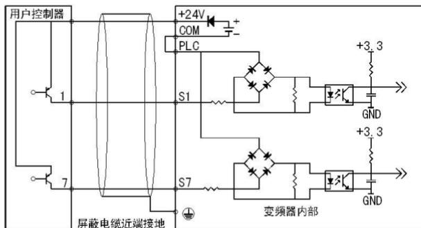
注：上图务必去除+24V与PLC端子间短路片，并将短路片连接在PLC与COM端子之间。
